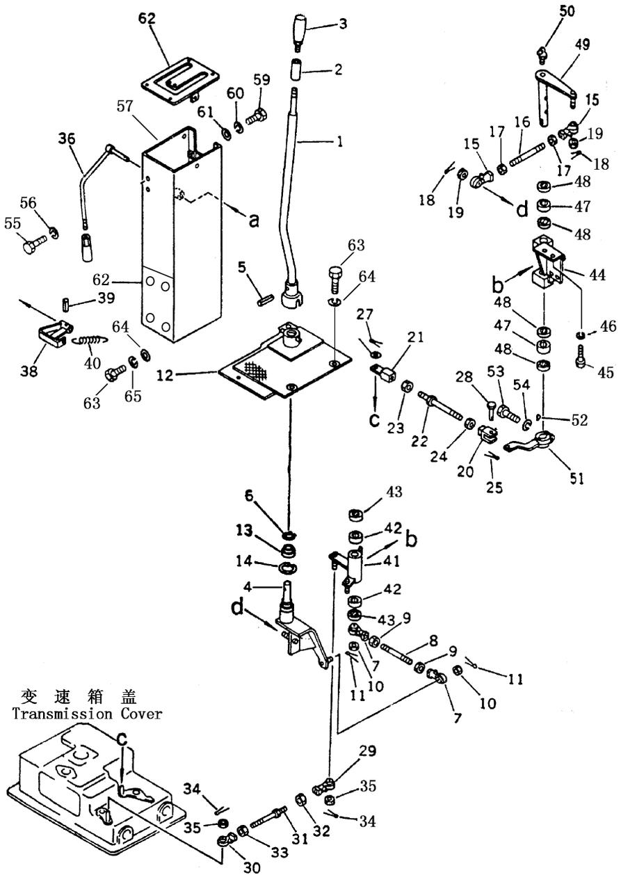
动力换挡变速箱变速杆
